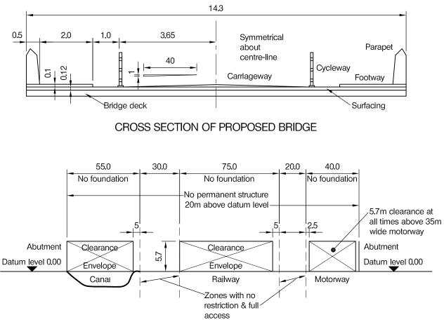
LONGITUDINAL SECTION SHOWING CLEARANCE ENVELOPES
